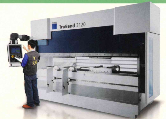
德國TRUMPF Trubend 3120 CNC油壓折床。
