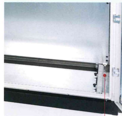
■底板滑組 可使完裝後之底板，上箱定位。往後滑動到後端停止時，再往上推行至定點，即可固定螺絲。
